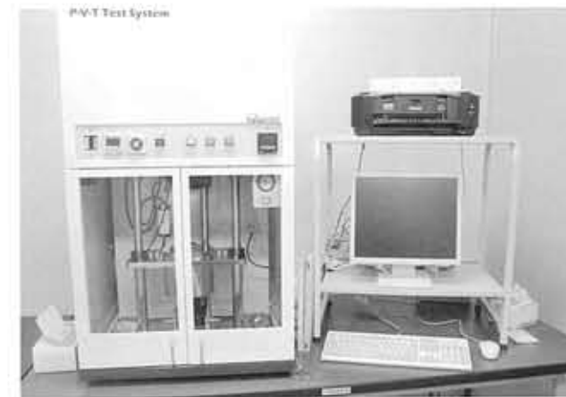
〔PVT試験機〕 熔融樹脂を計測して、樹脂特性を評価する
