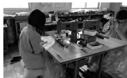
ウェルダーによるビニール溶着
