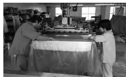
中継専用ウェルダーによる中継溶着
